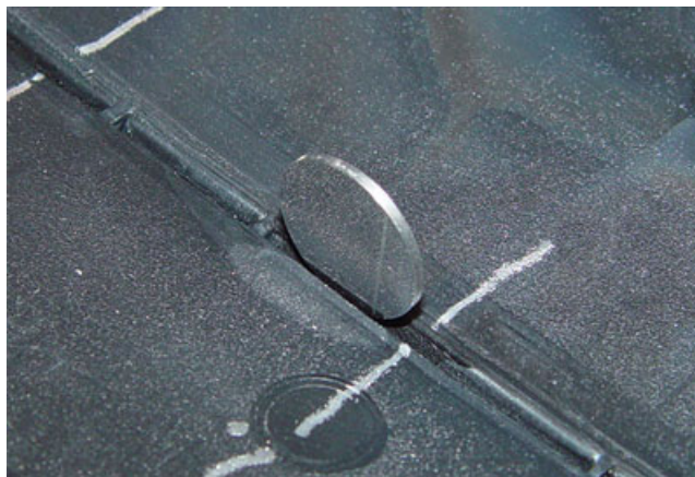
Obrázek 3. Umístění cílového kotoučku v odtrhávacím švu.
