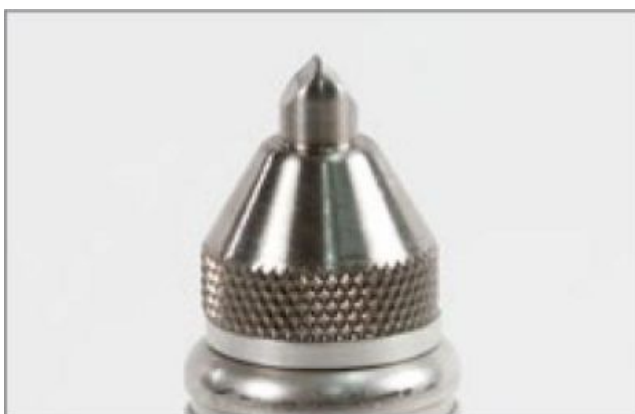
Obrázek 1. Detailní pohled na koncovou část snímače 86PR21-CWC.
